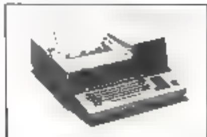
Doté d'une unité centrale de 64 à 128 K octets, ce système comprend un clavier machine à écrire standard (clavier numérique séparé), un tableau d'affichage à 28 caractères (ASCII) et une imprimante à aiguille 80 colonnes.
