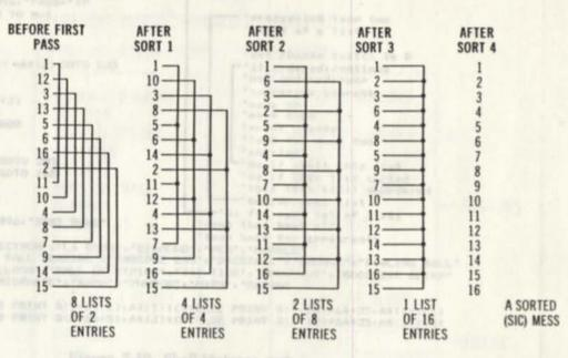
Figure 7-9. Shell-Metzner sort algorithm.
