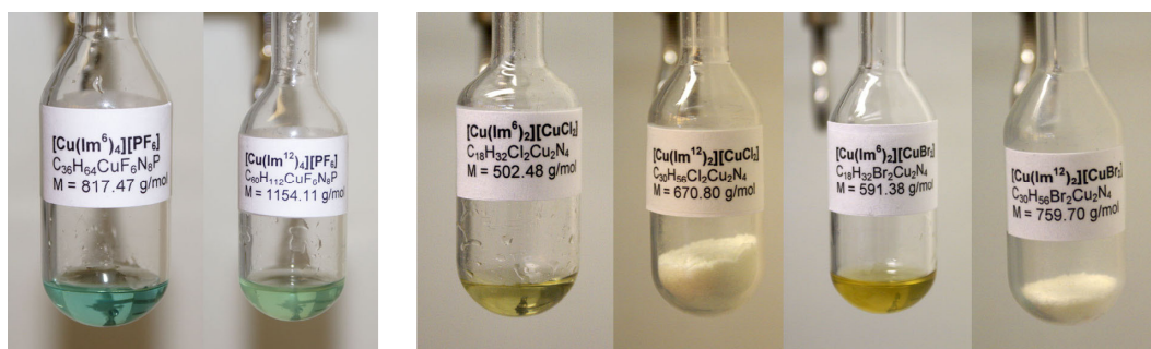
Abbildung 10 Ionische Flüssigkeiten [\text{Cu}(\text{Im}^n)_4]\text{PF}_6 vom Typ I (links) und ionische Flüssigkeiten [\text{Cu}(\text{Im}^n)_2][\text{CuX}_2] vom Typ II (rechts) in abgeschmolzenen Glasampullen; n = 6, 12 .
