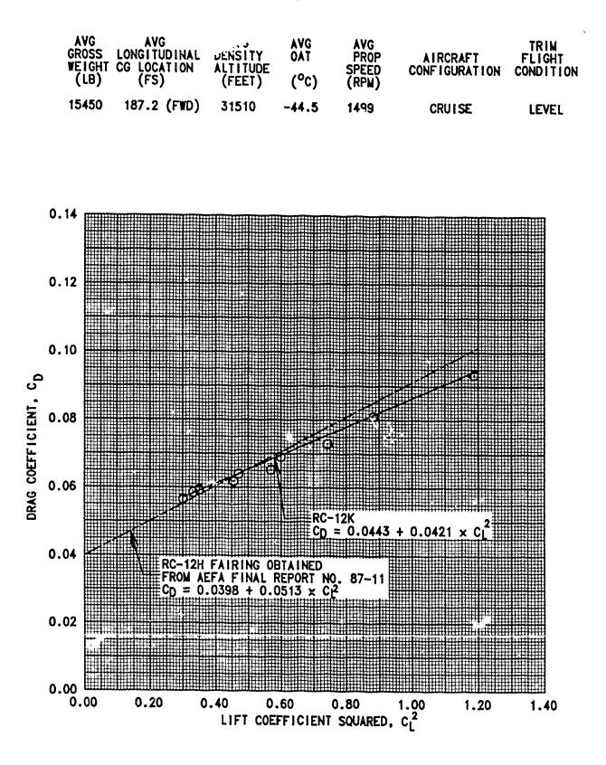
FIGURE E-3 DUAL ENGINE LEVEL FLIGHT PERFORMANCE RC-12K USA S/N 85-50149
