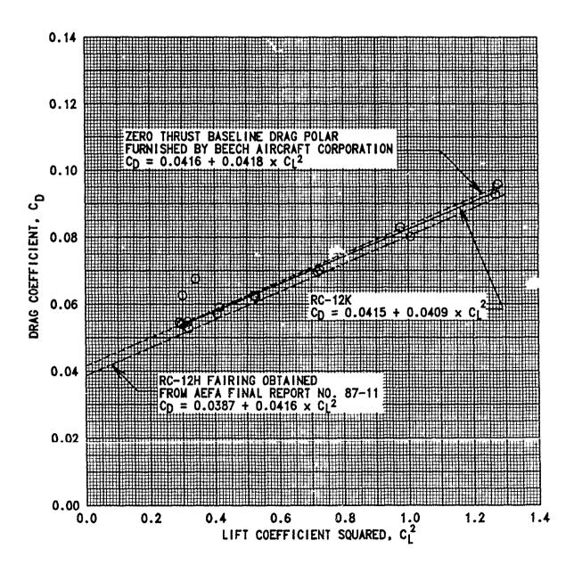
FIGURE E-2 DUAL ENGINE LEVEL FLIGHT DRAG POLAR RC-12K USA S/N 85-50149
