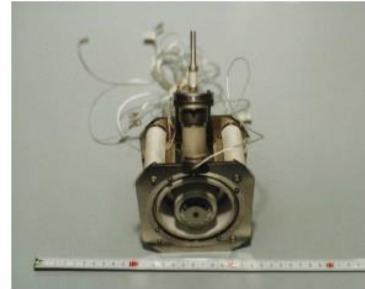
Fig. 4 The picture of mid-power HET
