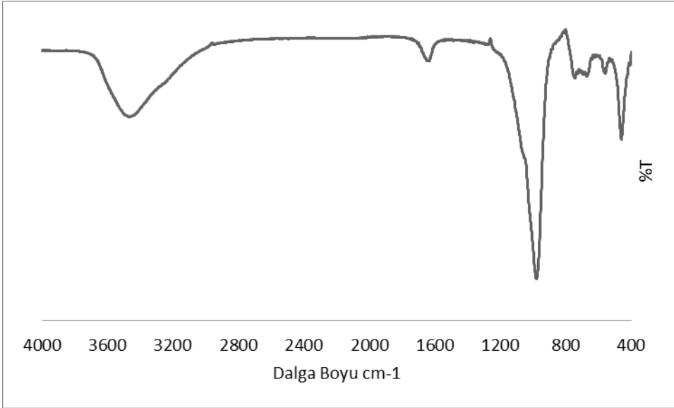
Şekil 7.29. Zeolit X için FTIR sonuçları
