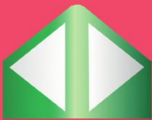
J14a > Balises de musoir, signalant la divergence des voies
