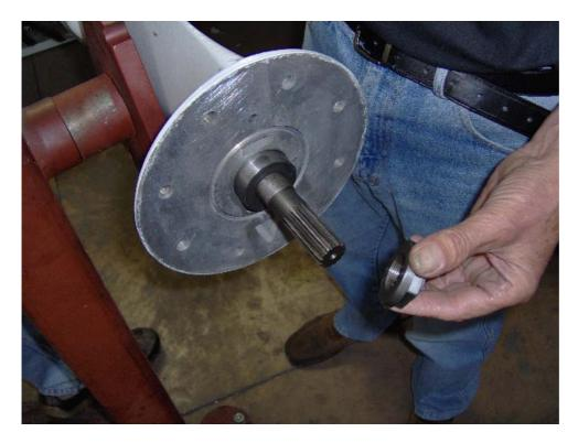
Insert bearing (rif. n° 62), insert and screw lock nut (rif. n° 61)
