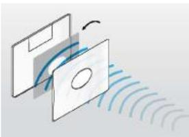
Funda rígido de policarbonato con una chapa de seguridad que bloquea la señales de radiofrecuencia e impide toda la lectura del contenido de las tarjetas de 13,56 Mhz.
