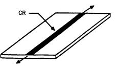
BUTT JOINTS — LONGITUDINAL (AXIAL LOAD) 2.1.5(A) — WELD REINFORCEMENT INTACT 2.1.6(A) — WELD REINFORCEMENT REMOVED
