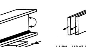
4.1.2(A) — LAP WELDED JOINT — PLATE STRESS CRITICAL (AXIAL LOAD)
