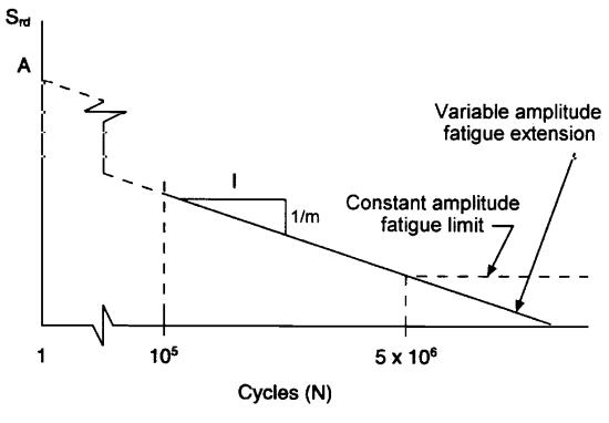
Figure 4.8.1-1 SCHEMATIC FATIGUE CURVE
