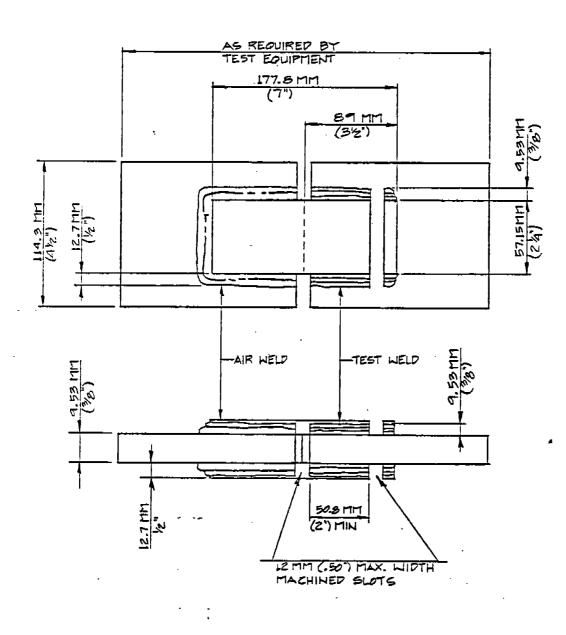
FIGURE A-10 FILLET WELD TENSILE TEST SPECIMEN
