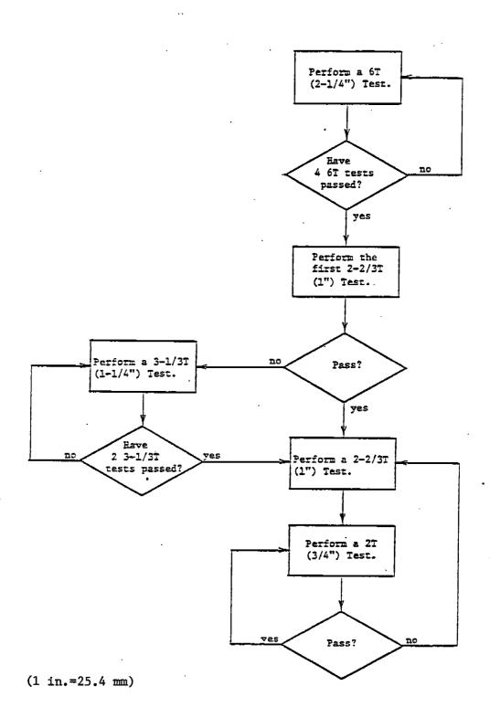
FIGURE A-4 SIDE BEND TEST PROCEDURE
