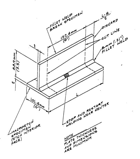
FIGURE A-9 FILLET WELD BREAK-OVER BEND TEST SPECIMEN
