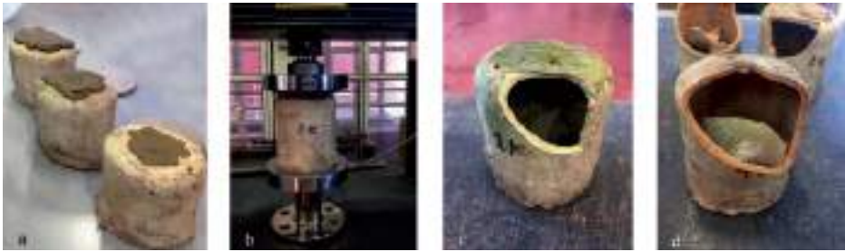
Fig. 6 – Caruselli: a) provini livellati con argilla; b) provino C2 sottoposto a prova di compressione; c) tipica rottura di un provino poco cotto (albase); d) rottura per provini ben cotti (mezzanelle)
