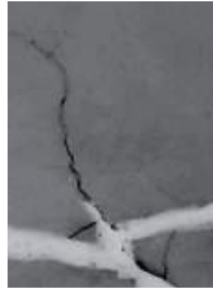
Fig.12 Vasca n. inv. 73003, dettaglio delle immagini radiografiche. Esempi di fessurazioni che si dipartono da cuspidi
