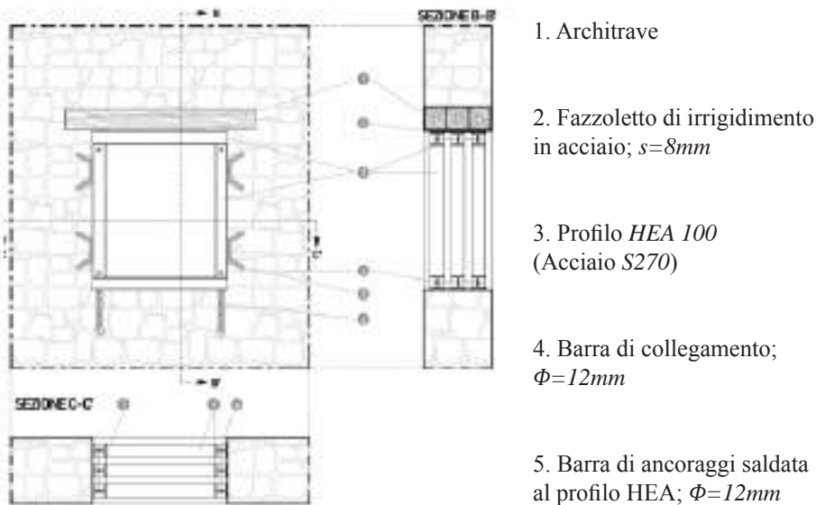
Figura 5 - Cerchiatura tipo utilizzata per il consolidamento dell'edificio
