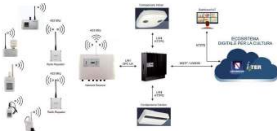
Fig.2 Architettura IoT e dettaglio della Rete.
