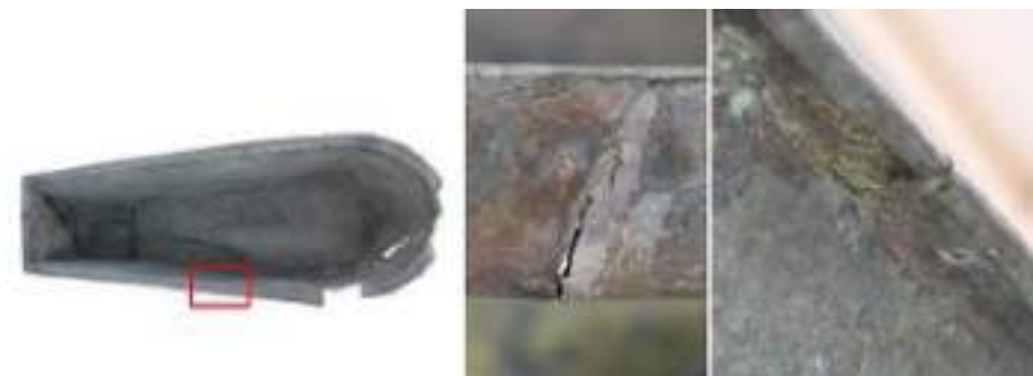
Fig. 10 - Vasca n. inv. 73003, orlo. Esempio di dettaglio delle fessurazioni presenti sull'orlo estroflesso.
