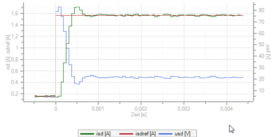
Bild 5.4.1.2 Current controller optimization
