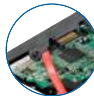
Coudé vers le bas ! Pour disque dur installé en haut !
