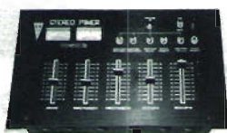
Miscelatore stereo con pre-ascolto in cuffia e indicatori di bilanciamento - Ingressi micro bassa e alta impedenza - aux - fono magnetico e fono piezo. L. 150.000
