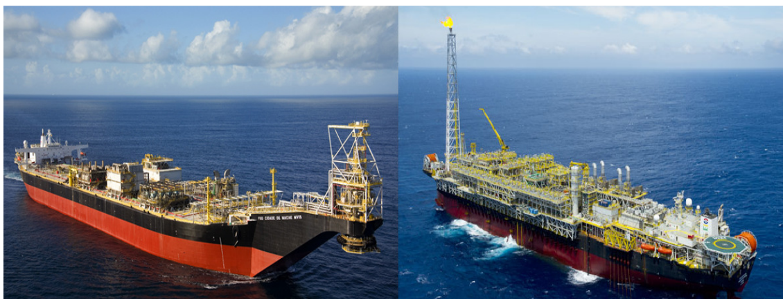
Figura II.28 – FSO (esquerda) versus FPSO (direita). Fonte: Modect, 2015.
