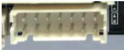
包含 1 路双片选信号 SPI，一路 I2C (I2C1)，4 路 GPIO (6,8,10,12 脚)
