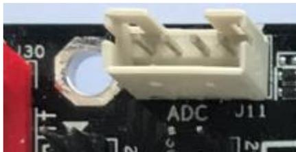
ADC 检测电压最高为 1.8V
