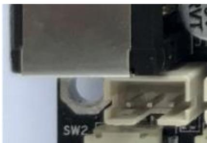
也可以作为普通 GPIO 试用，1 脚输出 3.3V 电压，2 脚位 LED 开关控制 GPIO
