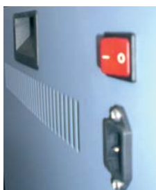
Interruptor general de carga
