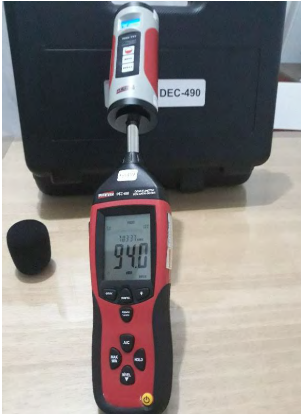
Figura 58 - Foto do medidor de nível de pressão sonora utilizado no levantamento de campo mostrando que está calibrado
