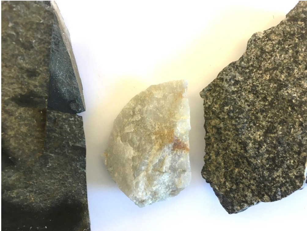
Figur 57. Dominerande bergarter vid Fäbodtjärn, från vänster till höger metasediment, kvarts och diorit.
