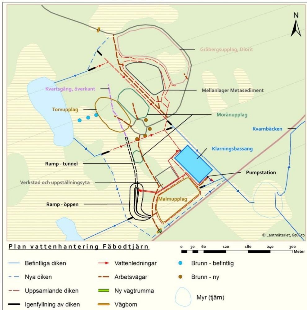
Figur 68. Översikt vattenhantering Fäbodtjärn.
