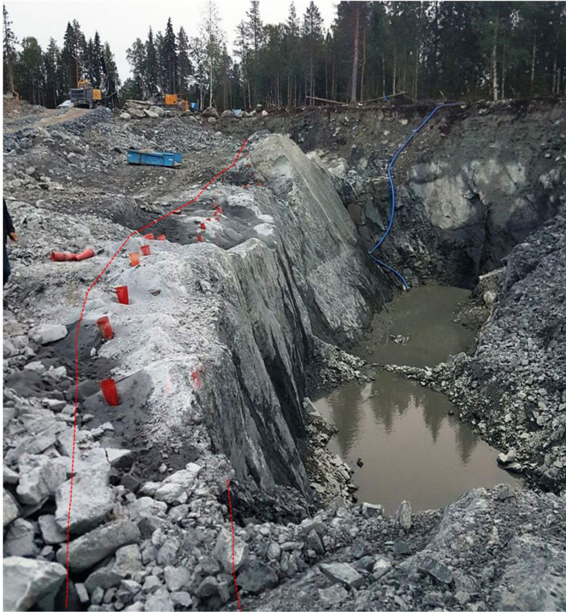
Figur 12. Bild på kvartsgången (förtydligad gräns med röda linjer) vid Fäbodtjärn sett från norr, med stupning åt vänster i bilden. Foto från provbrytning 2017.
