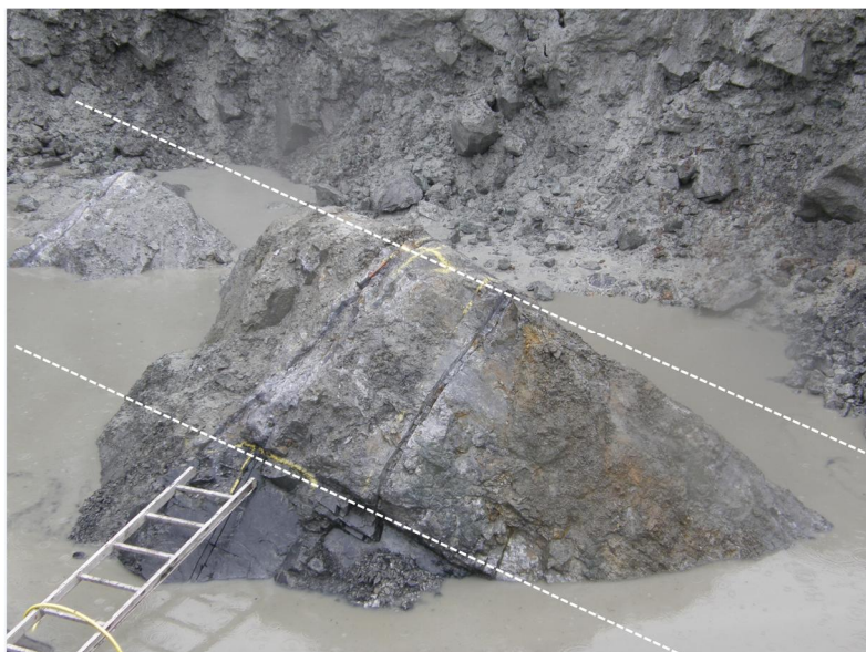
Figur 11. Bild på kvartsgången (utbredning utmed vita linjer) vid Fäbodtjärn, med stupning i riktning uppåt i bilden. I nedre delen av bilden (liggväggen) vid stegen syns svart metasediment (gråvacka). Foto från dikesgrävning 2016.
