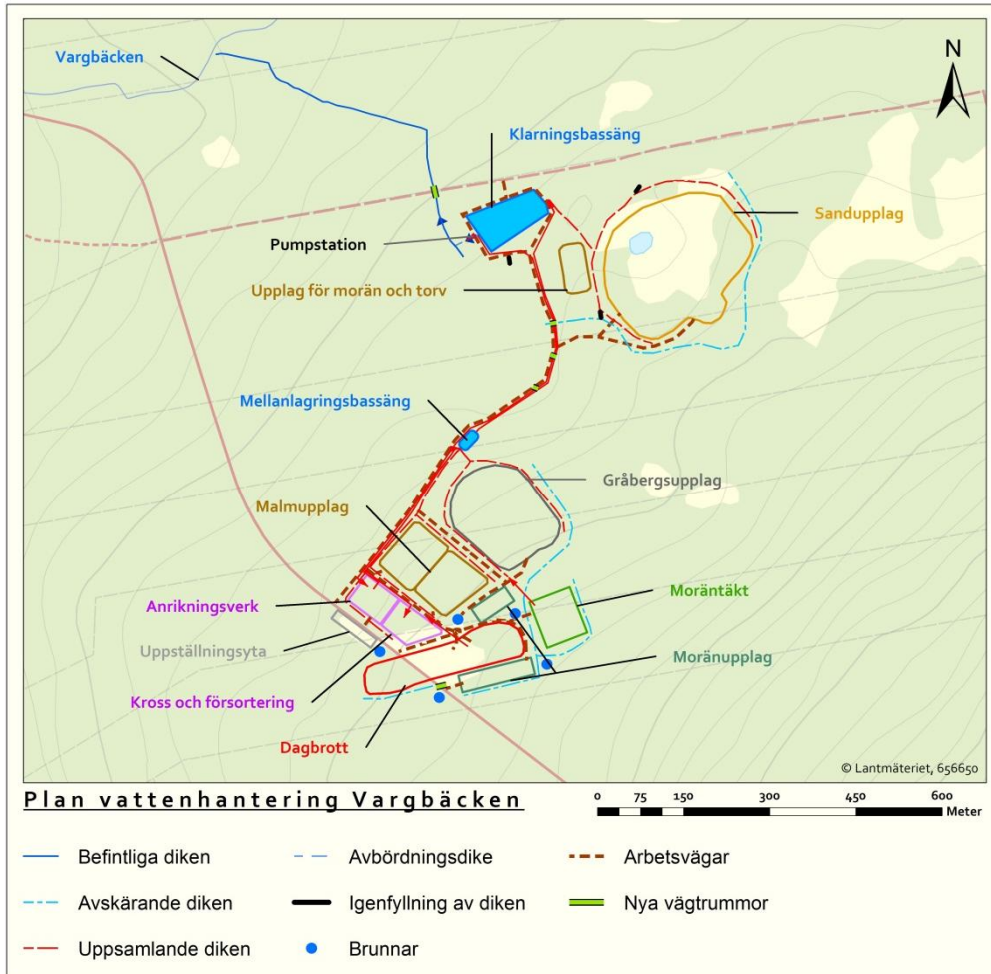
Figur 40. Översikt vattenhantering Vargbäcken (råvattenbrunnar ej visade).
