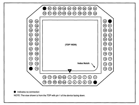
Figure 45. 84-Pin PLCC Actionprobe
