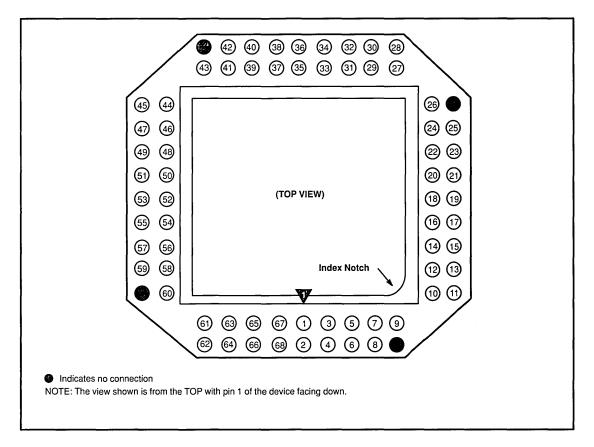
Figure 44. 68-Pin PLCC Actionprobe
