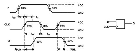
D FLIP-FLOP SHOWING POSITIVE-EDGE TRIGGERED CLOCK
