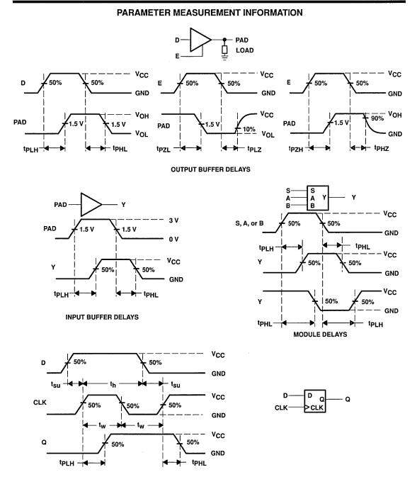
D FLIP-FLOP SHOWING POSITIVE-EDGE TRIGGERED CLOCK
