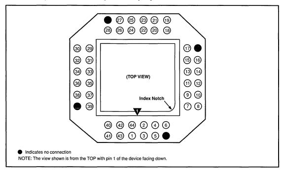
Figure 43. 44-Pin PLCC Actionprobe
