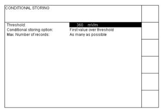
Fig. 13-2 CONDITIONAL STORING - Threshold menu
