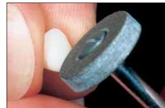
**SuperMax** - спеченный алмаз на органической связке. В процессе шлифования органическая связка поглощает выделяемое тепло, что предотвращает зону от перегрева. Назначение: керамика, металло-керамика, композиты, титан, сплавы всех видов, том числе хром-кобальт, золото, другие мягкие металлы и сплавы.
