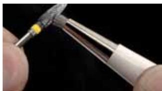
Металлическая щетка для очистки стальных и титановых инструментов. Щетка изготовлена из специальной стали V2A для предотвращения загрязнения поверхности фрез
