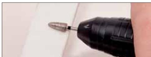
Инструменты из спеченного алмаза на металлической связке требуют регулярной очистки для поддержания режущей способности. Правильный камень НТИ **G9920** чистит и активирует поверхность, восстанавливает абразивную способность.
