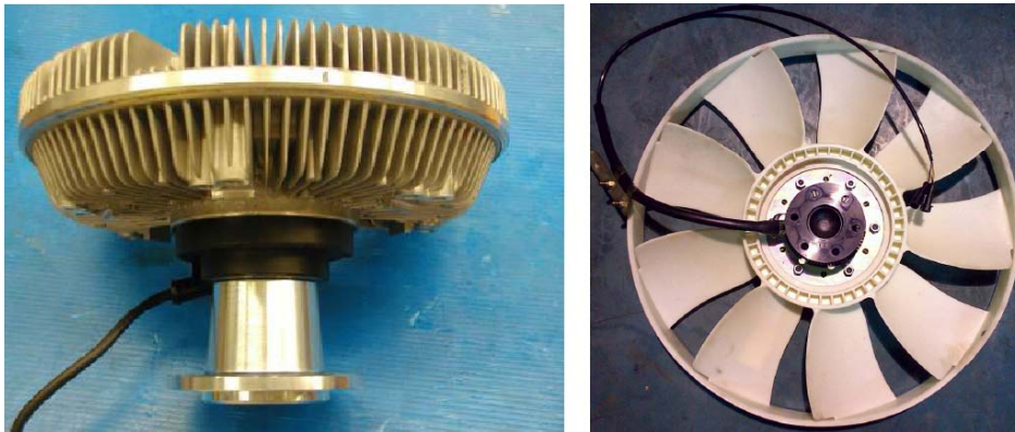
Fig. 3-1 Electronic fan clutch and electronic fan
