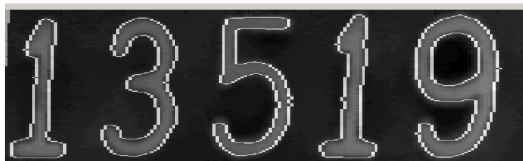
Figura 41. Impronta digital sobre una sección de la placa de identificación reconstruída.
