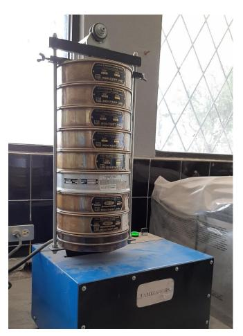
*Nota*. La figura indica el juego de tamices con el agregado grueso, colocado en el tamizador automático.
