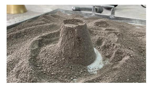
*Nota*. La figura indica el cono truncado, ligeramente derrumbado, esto indica que el material está en el estado correcto de SSS.
