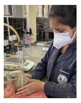
*Nota*. La figura indica la colocación de la bomba de vacíos en el picnómetro, con el objetivo de extraer el aire atrapado en el agregado.
