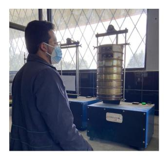
Nota. La figura indica la colocación del juego de tamices en el tamizador automático.
