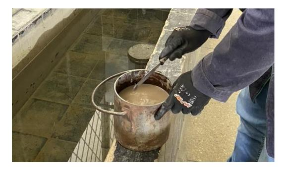
*Nota*. La figura indica el agregado fino en un balde metálico, donde se mantiene en sumersión durante 24 horas.
