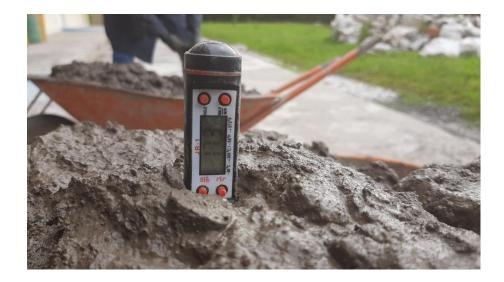
Nota. La figura indica la toma de temperatura en el hormigón fresco.
