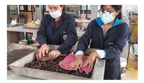
Nota. La figura indica el proceso de remoción de la humedad superficial del agregado grueso, hasta llegar a la condición de SSS.
