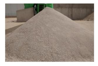
Nota. La figura evidencia una muestra de agregado fino seco. Tomado de *Tecnología del Concreto y Mortero* (pg. 49), por G. Rivera López, 2013, Universidad del Cauca.
