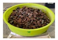
Nota. La figura indica una muestra del agregado grueso de ¾" este material proviene de la cantera de Pintag.
