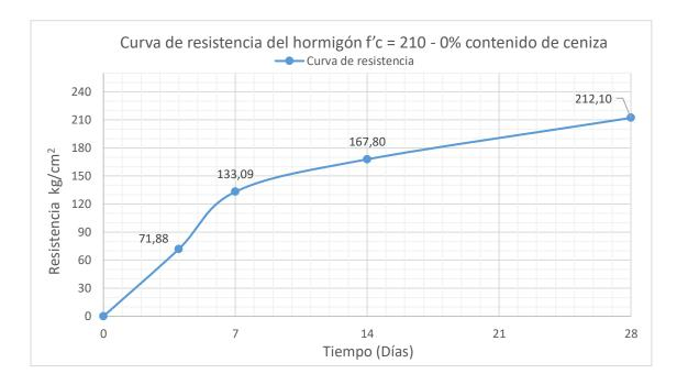
*Nota*. Curva de evolución de la resistencia del hormigón en el tiempo, los valores representan las resistencias obtenidas con un  $f'c = 210 \text{ kg/cm}^2 \text{ y } 0 \%$  de ceniza.
