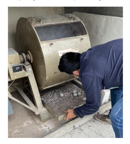
*Nota*. La figura indica la retirada del material ensayado, junto a las cargas abrasivas (esferas de acero) utilizadas para el desgaste del árido grueso.
