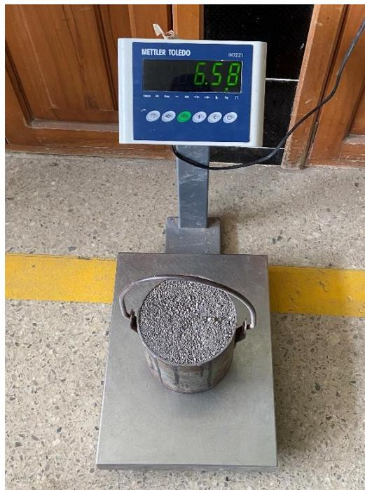
*Nota.* La figura indica el peso del balde metálico y el agregado fino compactado.
