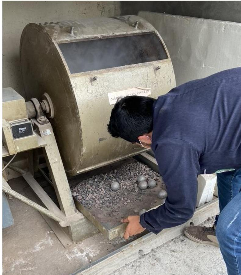
*Nota.* La figura indica la retirada del material ensayado, junto a las cargas abrasivas (esferas de acero) utilizadas para el desgaste del árido grueso.
