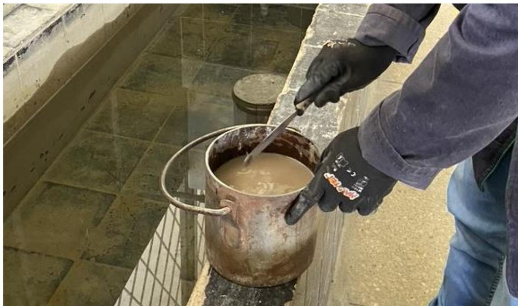
*Nota.* La figura indica el agregado fino en un balde metálico, donde se mantiene en sumersión durante 24 horas.
