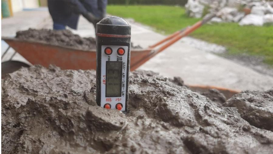
*Nota.* La figura indica la toma de temperatura en el hormigón fresco.
