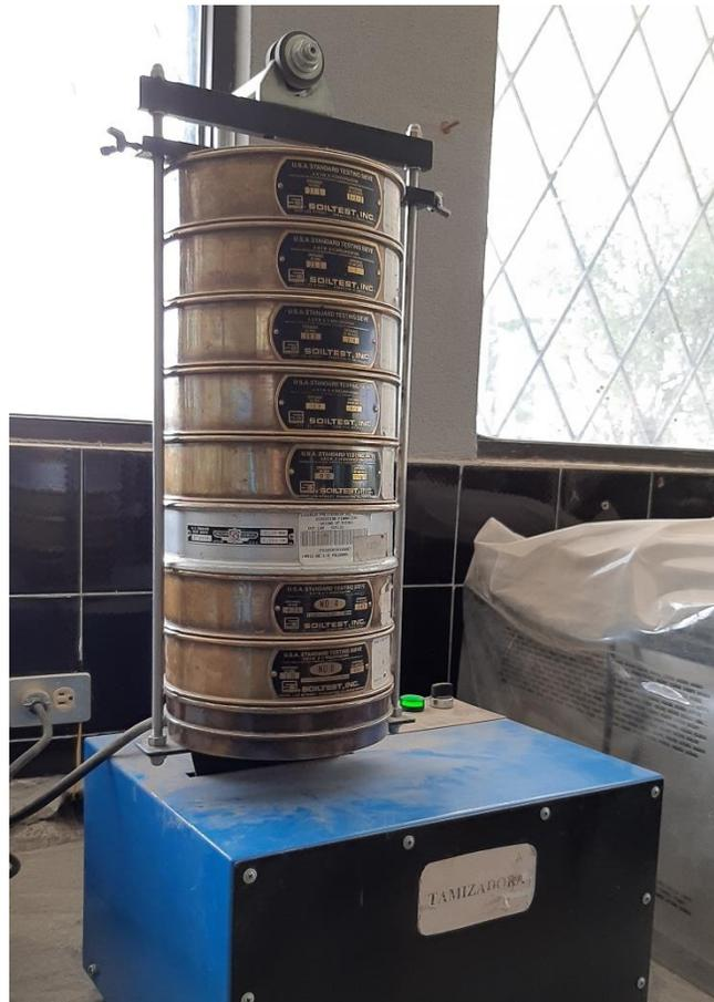
*Nota.* La figura indica el juego de tamices con el agregado grueso, colocado en el tamizador automático.
