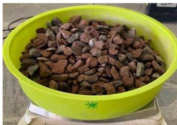
*Nota.* La figura indica una muestra del agregado grueso de 3/4" este material proviene de la cantera de Pintag.
