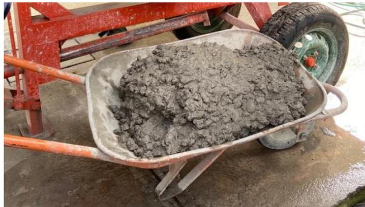
*Nota.* La imagen indica una muestra de hormigón fresco.
