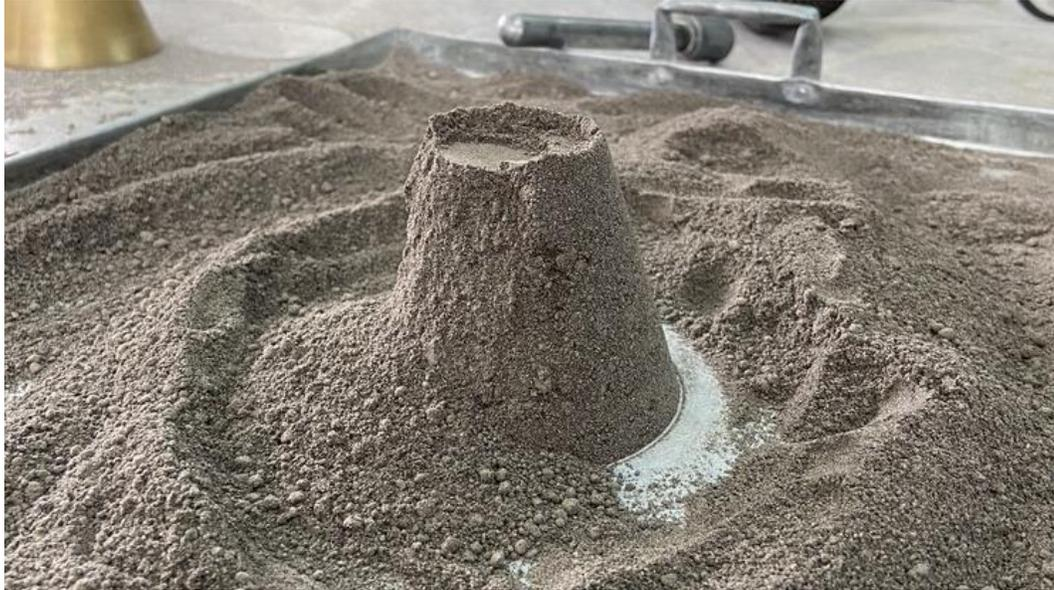
*Nota.* La figura indica el cono truncado, ligeramente derrumbado, esto indica que el material está en el estado correcto de SSS.
