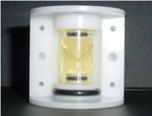
Abbildung 4.2: Gussform Version II (ohne Silikonmantel)
