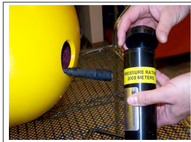
Figure 9-19: Placing the Cap on the PAR
