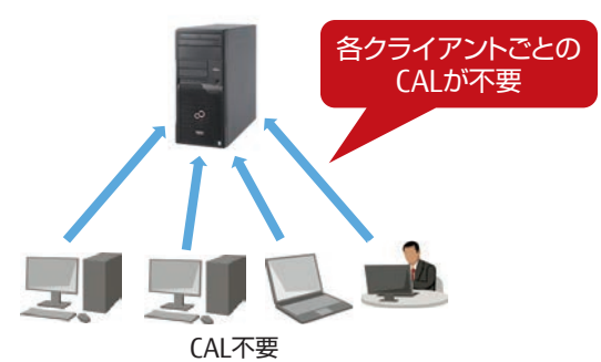
Windows® Storage Server 2016 Standard の場合
