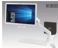
VESA規格 (100×100mm、75×75mm) に適合し、FMV-MKAM2:質量3.5~6.5kg、FMV-MKAM3:質量2.3~5.0kgのディスプレイ(表示部)及び搭載装置(ディスプレイ部に装置を搭載した場合)に対応しています。
