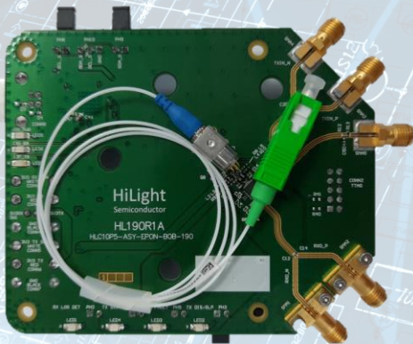
10G-PON ONU BoB RDK – 2 layer PCB HLC10P5 Combo IC
