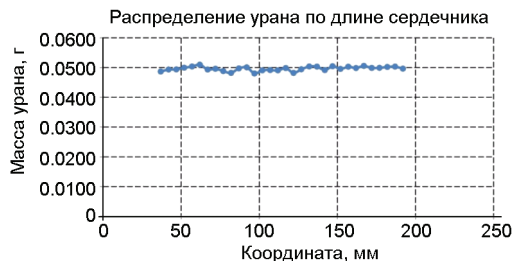
Рис. 6. Распределение урана по длине сердечника КОПС41.
