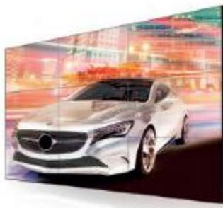
Marca: 47WV50B Fabricante: LG. Configuração: MONITOR PROFISSIONAL para VIDEO WALL; LED FULL HD - 47"; resolução de 1920 x 1080; Brilho de 500 cd/m2; Tempo de resposta 12ms; Tecnologia IPS; 16:09; Chip para tratamento de imagem; Controle remoto; Suporte de parede incluso; cabo de alimentação; Garantia de 1 ano.
