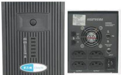
Fabricante: Eaton Modelo: ENV1400LB Configuração: Nobreak - 1400va - Torre; Potência de Saída: 1400VA/840W; Linha Interativa; Fator de potência: 0,6; A bateria é do tipo estacionária, selada, valvula regulada; Alarme para bateria, falha, temperatura excedente e sobrecarga; Tensão de entrada de 120V. Plugue de tomada padrão NBR 14136. Garantia 1 ano on-site.
