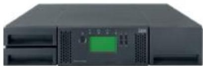
Marca: TS3200. Fabricante: LENOVO. Descrição: Biblioteca de Fita de 04U Altura sendo LTO-6 com 02 Drivers FC 08Gbps para conexão ao Servidor, 48 Slots para Cartuchos, 01 Porta RJ45 de Gerenciamento, Host. Garantia de 3 anos on-site.
