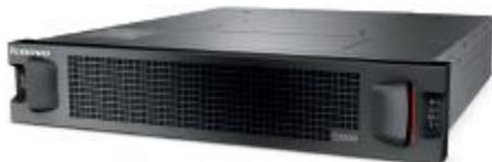
Marca: Storage S3200. Fabricante: LENOVO. Descrição: Storage de Rack com 02U de Altura, 02 Controladoras Redundantes, Cache de 12GB (06GB por Controladora), 08 Portas CNC SFP+ 1/10Gbps iSCSI ou 8/16Gbps FC (04 Portas por Controladora), 12 Discos Hot-Swap de 02TB NL-SAS 3.5" 7.2k RPM, Fontes Redundantes e Hot-Swap, Tierização, Snapshot, ThinProvisioning, SSD Read Cache. Gerenciamento Dedicado. Garantia 3 anos on-site.
