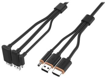
Le câble 3-en-1 permet de connecter les câbles HDMI,USB et d'alimentation entre la boîte de liaison et le casque Vive.
