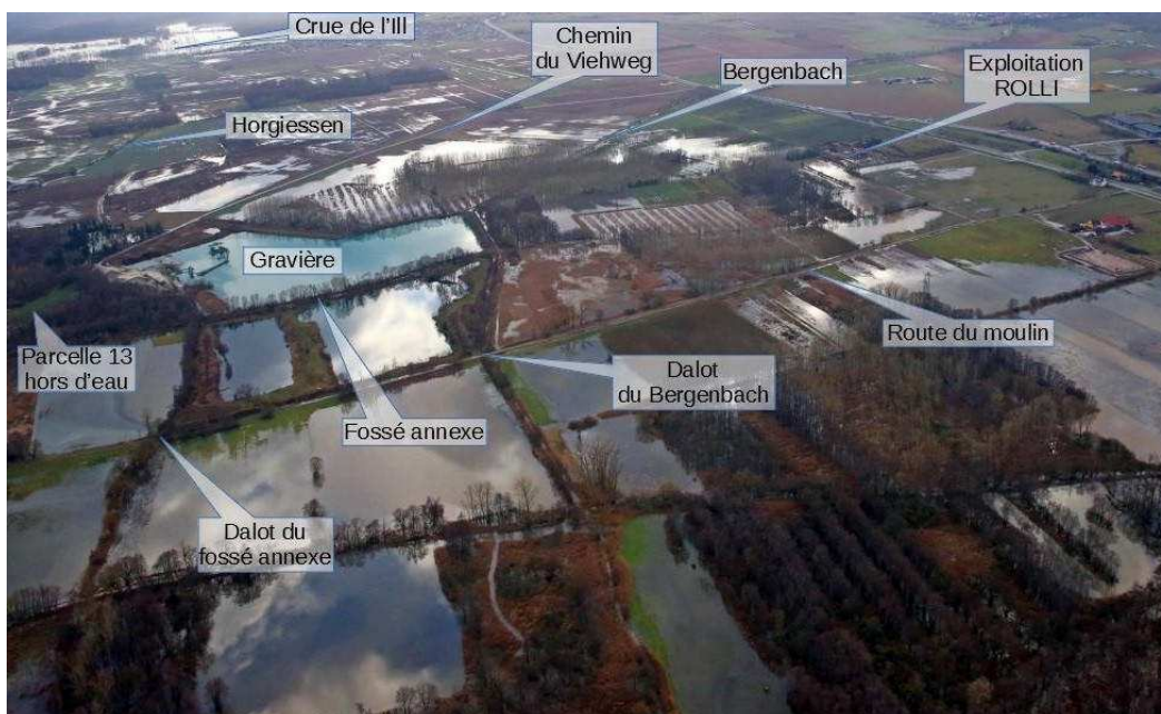
Le chemin du Viehweg et la route du moulin sont secs. La parcelle 13, inondée en 1990, est sèche. Le Bergенbach déborde dans la cuvette de Bruhly délimitée et endiguée par ces chemins et par les gravières.
