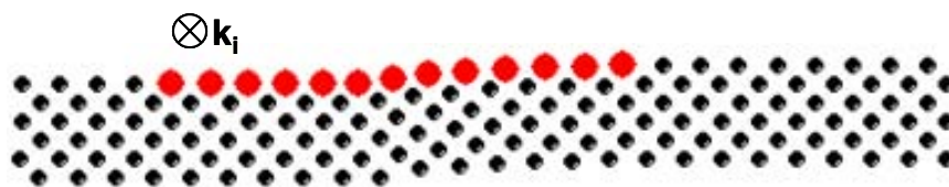
Fig. III-34 – Couche de MgO au voisinage d'une dislocation créée par montée. Les positions atomiques sont calculées d'après [80]. Les atomes de la surface considérés dans le calcul de l'intensité diffractée sont mis en évidence. Les électrons incidents ont un vecteur d'onde \mathbf{k}_i perpendiculaire au plan de la figure.
