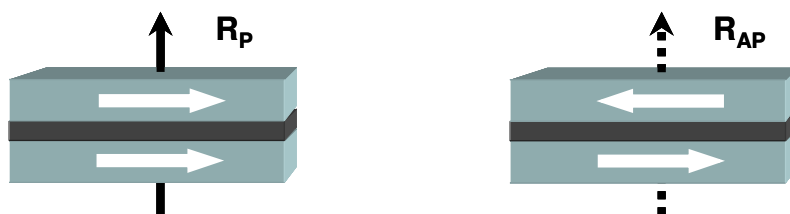
Fig. I-1 – Jonction tunnel magnétique constituée de deux électrodes ferromagnétiques séparées par une couche isolante. La direction des aimantations est représentée par les flèches blanches. La TMR est positive lorsque la résistance est plus élevée en configuration parallèle ( R_P ) qu'en configuration antiparallèle ( R_{AP} ).
