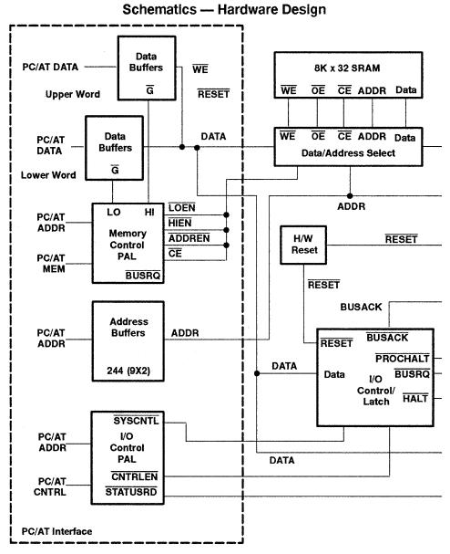
Figure 8(a). Block Diagram
