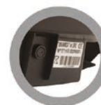
VANO PER FUSIBILE, UTILE PER LA PROTEZIONE ELETTRICA DELLA MACCHINA
