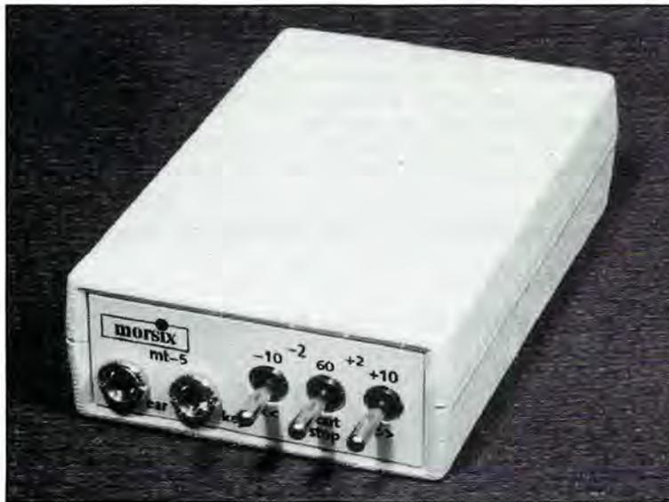
jack de 3,5 mm. L'un de ces jacks est réservé au branchement d'un écouteur, d'un casque (un casque de walkman à 20 balles fera l'affaire) ou d'une petite enceinte amplifiée, l'autre est prévu pour recevoir un manipulateur (type pioche), entraînement à l'émission oblige. Les trois inverseurs (deux contacts + une position centrale) servent à commander les nombreuses fonctions dont dispose Morsix. En dessous, une petite trappe donne accès
