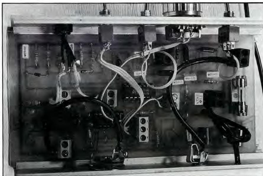
micro PC et d'autre part au haut-parleur du récepteur radio ou à une sortie BF auxiliaire. Le signal électrique issu du récepteur radio est ainsi transformé en signaux carrés qui sont ensuite acheminés vers le port série du micro-ordinateur puis traduits par le logiciel décrit ci-après,
