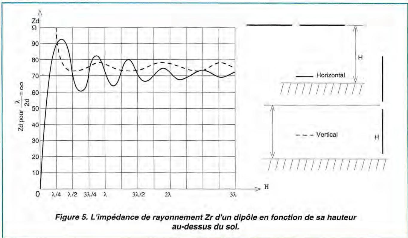
Figure 5. L'impédance de rayonnement  $Z_r$  d'un dipôle en fonction de sa hauteur au-dessus du sol.
