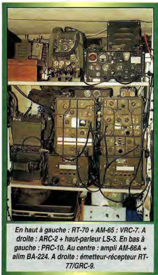
En haut à gauche : RT-70 + AM-65 : VRC-7. A droite : ARC-2 + haut-parleur LS-3. En bas à gauche : PRC-10. Au centre : ampli AM-66A + alim BA-224. A droite : émetteur-récepteur RT-77/GRC-9.
