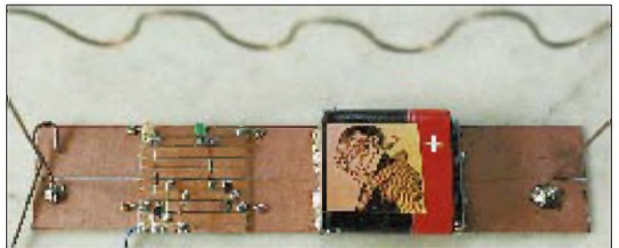
Tongenerator nachgeschaltet werden. Der mechanische Aufbau mit Integration der Streifenleiterplatte* auf einer längsgeritzten kupferbeschichteten Epoxidharzplatte wurde ebenfalls von Dr. Ingo Goltz entwickelt. Fotos: Wolfgang Lipps, DL4OAD
