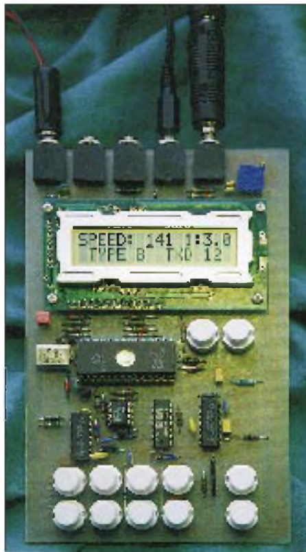
Bild 4: Prototyp der Elbug „Hallberg 1“
