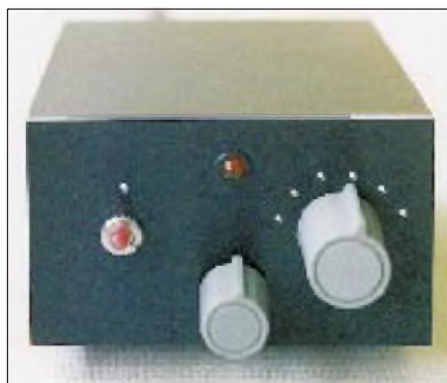
Bild 10: Frontansicht des betriebsfertigen Preselektors mit der gravierten Frontplatte aus PVC Fotos: DL2JDN
