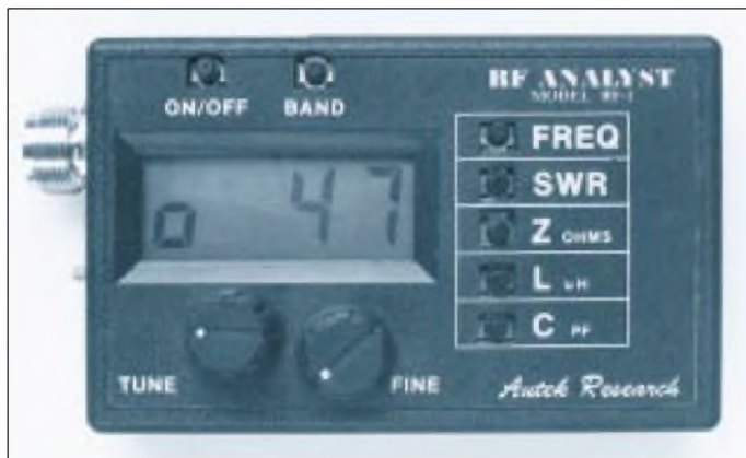
Bild 3: Außenansicht des RF-1 beim Messen eines ohmschen Widerstands von 47 \Omega im Z-Status. Das kleine \Omega symbolisiert das \Omega . Unten die Knöpfe für die Frequenz-Grobeeinstellung per Drehkondensator und die Feinjustierung mittels Miniaturpotentiometer. In Verlängerung der Display-Unterkante die M3-Masseschraube.
