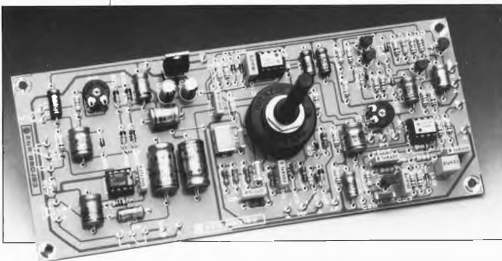
Figure 3. Représentation de la sérigraphie de l'implantation des composants. La quasi-totalité des composants et le contacteur rotatif prennent place sur le circuit imprimé qui sera monté en gigogne à l'arrière de la face avant.
