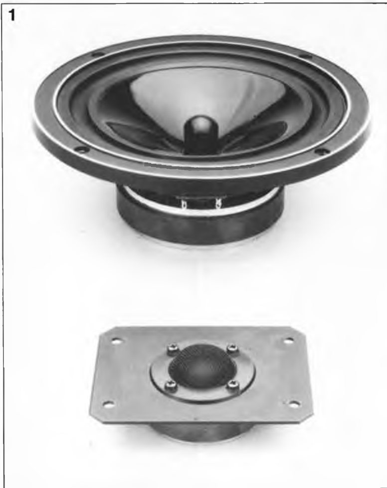
Figure 1. Vue rapprochée des deux haut-parleurs de la MTX 50P: un tweeter de 25 mm TWH 104 et un woofer TPX de 20 cm BMH 407, avant leur implantation dans le coffret.
