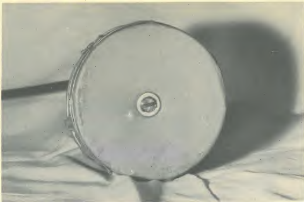
Notare la testa della vite, la rondella e la membrana incollati usando un adesivo I.S.
