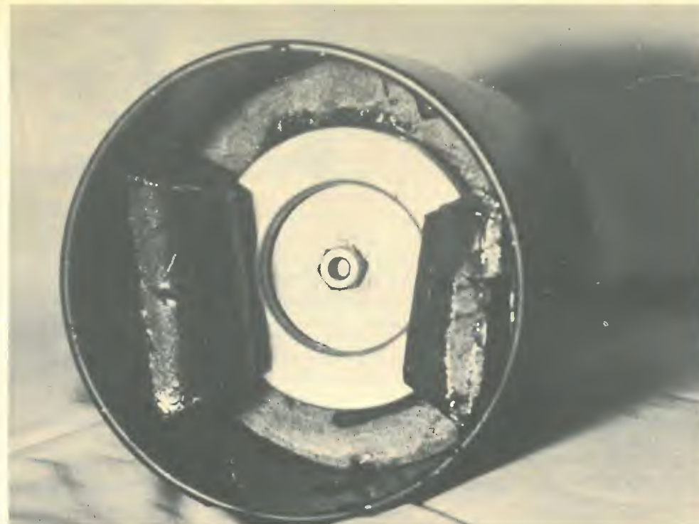
Particolare di costruzione del bussolotto: i pesi di piombo e il dado incollato alla membrana della capsula.
