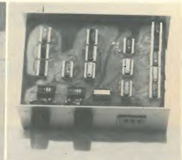
Potete notare lo stampato montato superiormente durante le prove, per l'ingombro dei commutatori che non ne permettevano il montaggio sul fondo.
