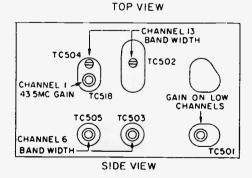
Fig. 6. Tuner Layout.
