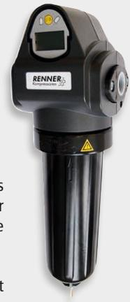
RENNER Druckluftfilter sind zum Abscheiden von Öl- und Wasseraerosolen sowie zur Entfernung von festen Verunreinigungen aus der Druckluft vorgesehen. Selbst Stäube werden an der Oberfläche und in der Tiefe des Filtermaterials sicher zurückgehalten. Unter Ausnutzung verschiedener Filtrationsmechanismen – wie Abscheidung durch direktes Abfangen, Trägheitsaufprall und Braunsche Molekularbewegung – erzielt man eine nahezu hundertprozentige Abscheideleistung.
