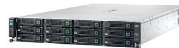
Vorderseite mit 12 x 3,5"-Festplatten
