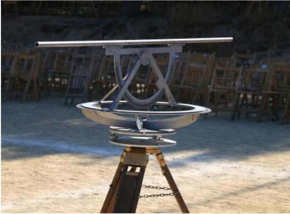
Dioptra reconstruite et présentée dans les actes de Tarraco Viva de 2006. Tarragone..
