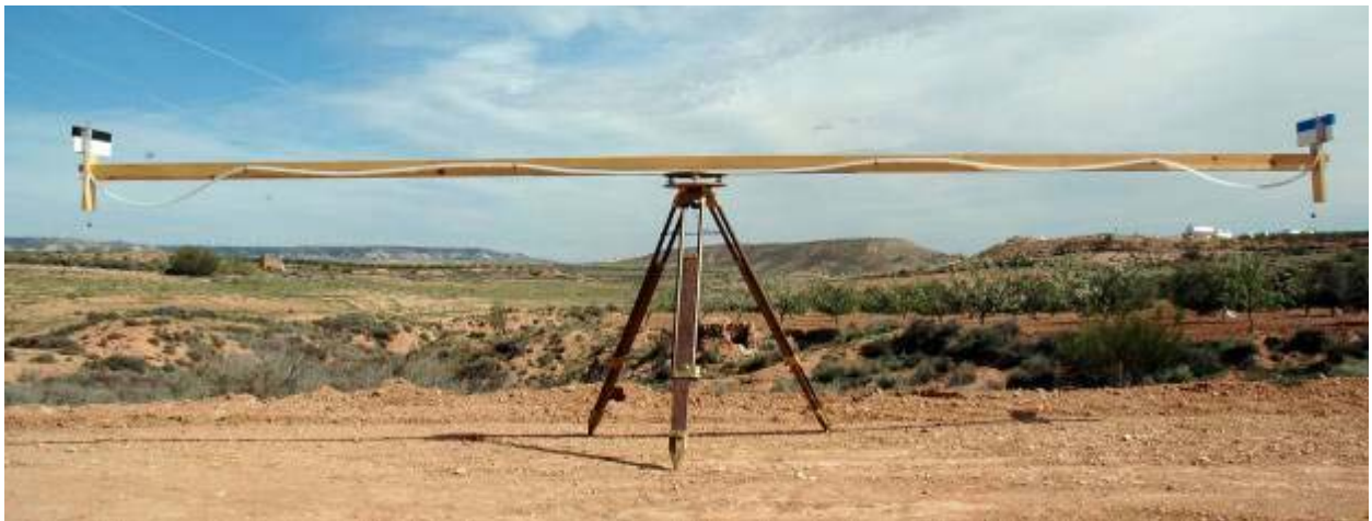
Chorobate romain mis en place et prêt à l'utilisation.
