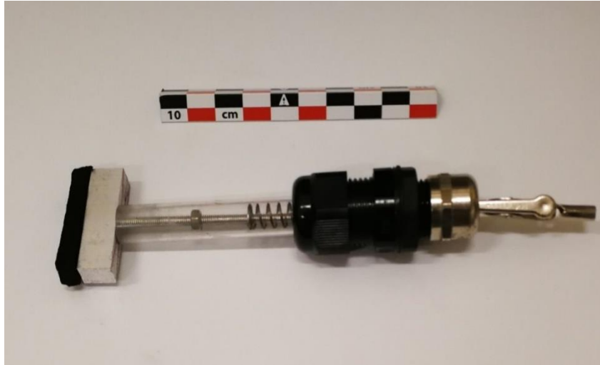
Figure 52 : Electrode développée avec embout permettant d'épouser la surface des échantillons et utilisée pour les analyses de calibration de résistivité en fonction de la teneur en eau.
