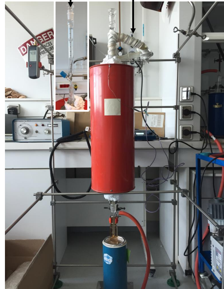
Schéma et photographies du dispositif réalisé au laboratoire pour la mise en œuvre du procédé de thermolyse sous vide
