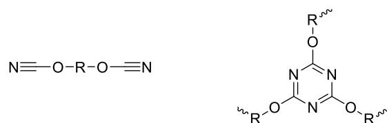
Figure 1.12 : Structure type des résines cyanate ester (gauche) et réseau triazine formé après polymérisation (droite)
