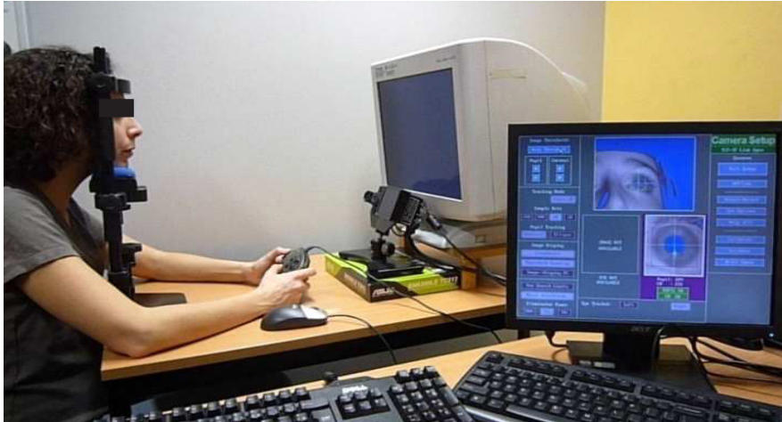
Figure A.30 : Dispositif expérimental utilisé pour l'oculométrie.
